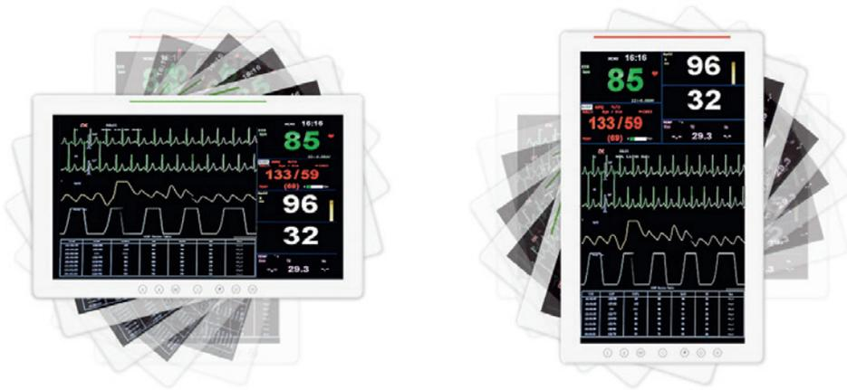
Der All-in-one PC kann sowohl im Landscape- als auch Potrait-Modus betrieben werden. Dabei schaltet die am oberen Rahmen befindliche LED-Leiste sowie das Touch-Tastenfeld am unteren Rahmen bei Drehung automatisch um, so dass das Gerät immer bedient werden kann, ohne den Kopf zur Seite zu drehen. Je nach Anwendungsfall bzw. -software wird damit der Bildschirmbereich optimal ausgenutzt.
