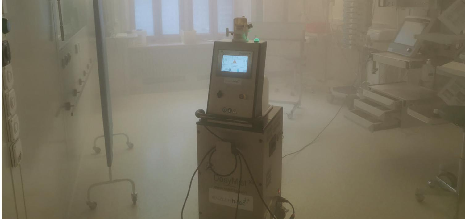
Abb. 3B: Durch die Abgabe feinsten, uniformen Tröpfchen wird ein lückenloser Oberflächenfilm gebildet und damit die Dekontamination bis in die kleinsten Ritzen sichergestellt.
