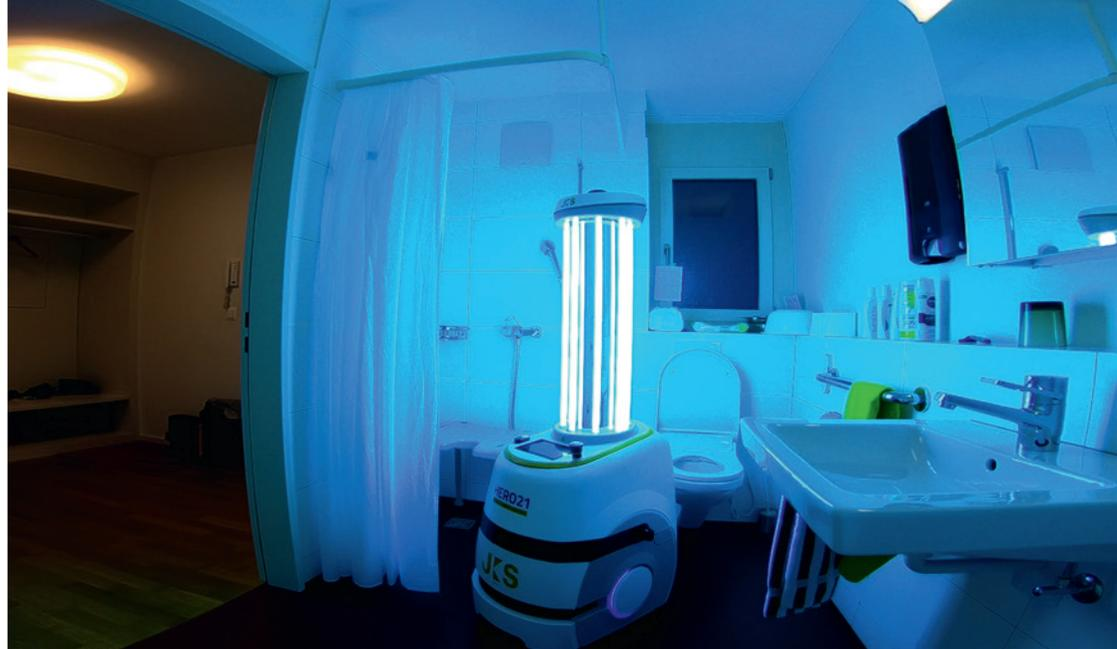
Abb. 3A: UV-C Roboter bewegen sich frei im Raum und minimieren damit den Schattenwurf.
