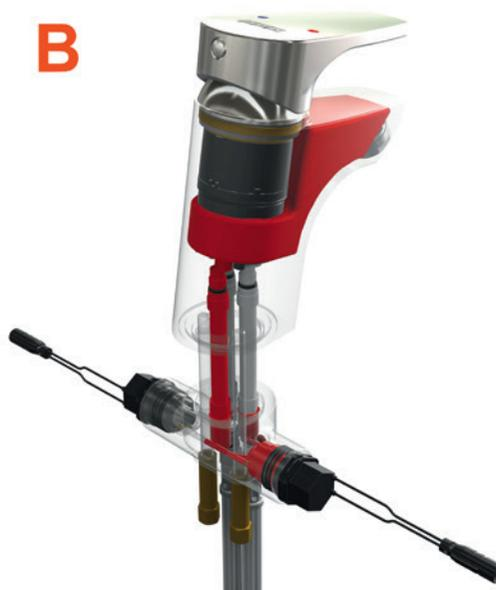
B: Thermische Desinfektion – Erhitzen des Wassers in den Armaturteilen auf 70°C
